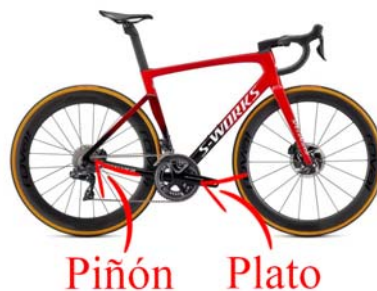
Figura 2: Partes relevantes de la transmisión de una bicicleta.
